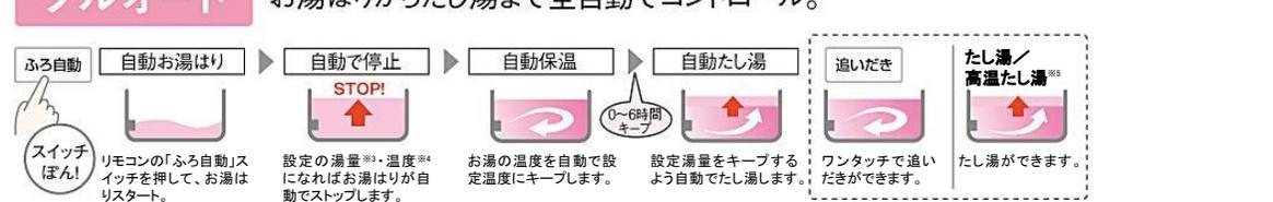
※3: 100L~500L(20L刻み)の湯量設定ができます。ふる湯量設定の最低湯量はふる接続アダプタの位置および浴槽の大きさによって変化します。 ※4: 水・38℃~48℃の1℃刻みで湯温設定ができます。 ※5: メニュー内の「たし湯」を選択すると設定温度のお湯を約20L、「高温たし湯」を選択すると約60℃のお湯を約20L注します。
